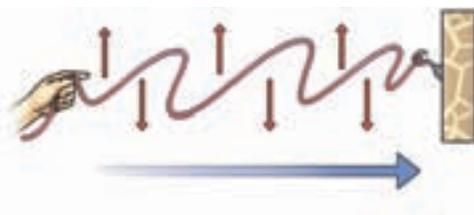
Onda secundaria o transversal. Los movimientos de las partículas del medio que transportan la onda son perpendiculares a la dirección de propagación de la perturbación.
